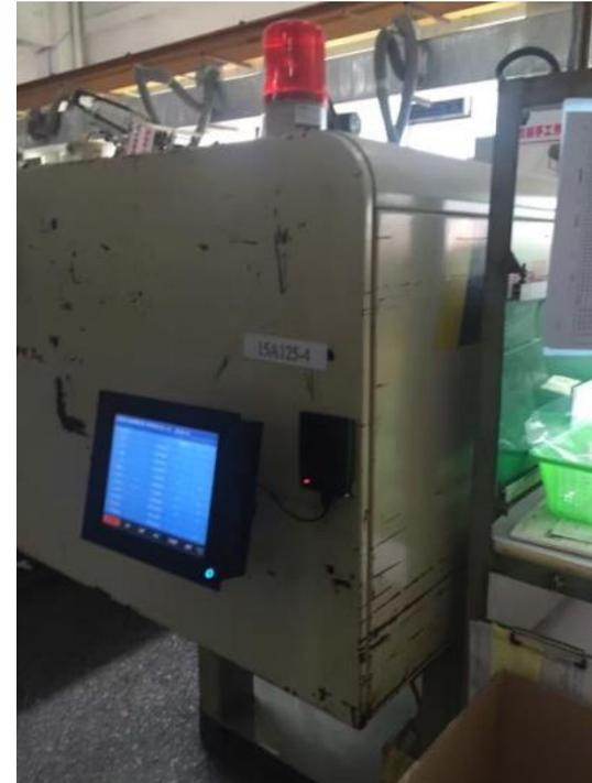
生产批次多，需经常换产的机台、产线旁边就近配置触摸屏工业电脑（智能终端），实现车间各种数据的即时采集与处理。
